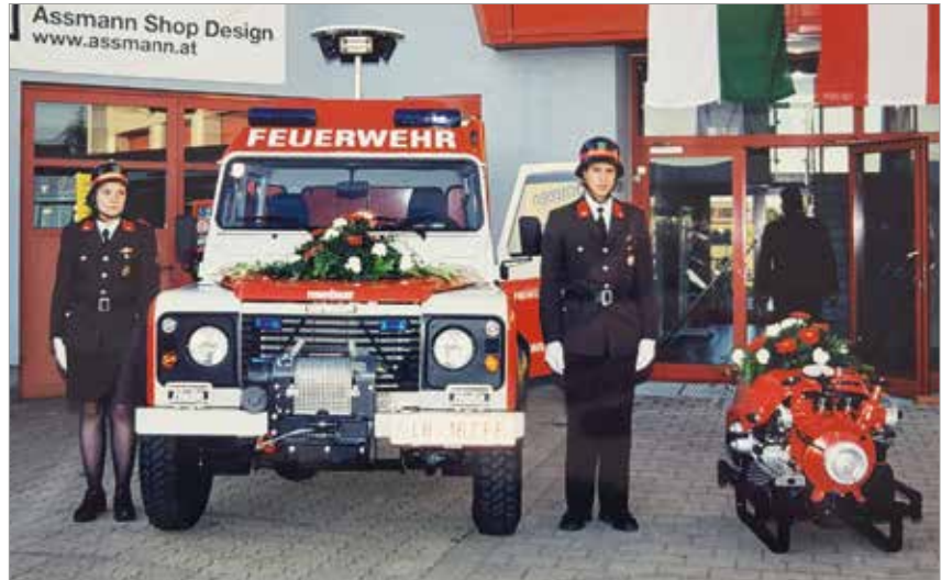
Kleinrüstfahrzeug Landrover 130 Defender mit Allrad, Bergeausrüstung & Tragkraftspritze 12 Fox
